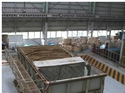
擁壁が大きく前方へ回転。すべり面の角度は30度以下。
