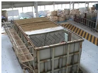
擁壁が前方へ約3度回転。盛土内にすべり面が発生。 大きなすべり面角度は45度。
